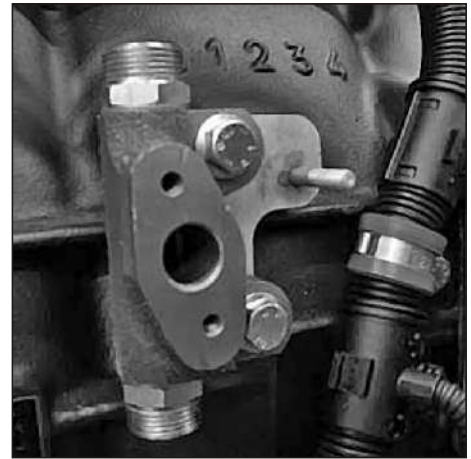
Рис. 126. Установка корпуса датчика давления и температуры топлива.
