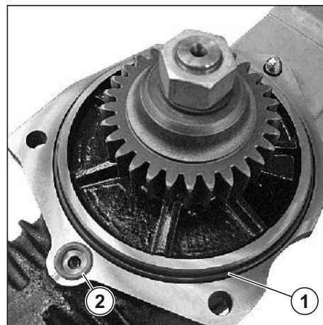
Рис. 112. Установка компрессора воздушного.
