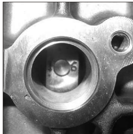
Рис. 121. ВМТ первого и шестого цилиндров
