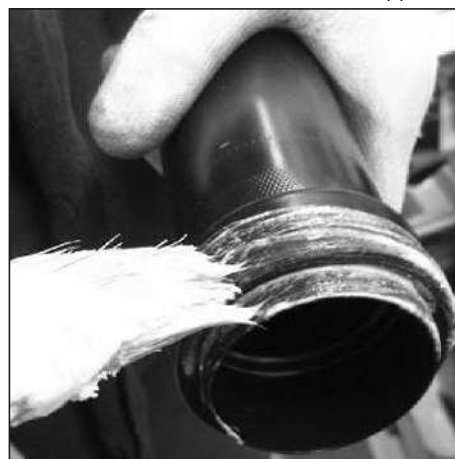
Рис. 130. Установка уплотнительного кольца трубы подводящей насоса водяного.
