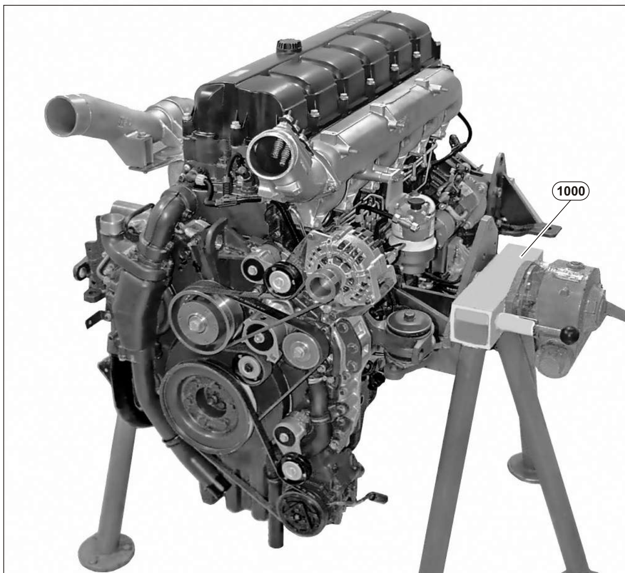
Рис. 7. Установка двигателя на универсальную стойку.
