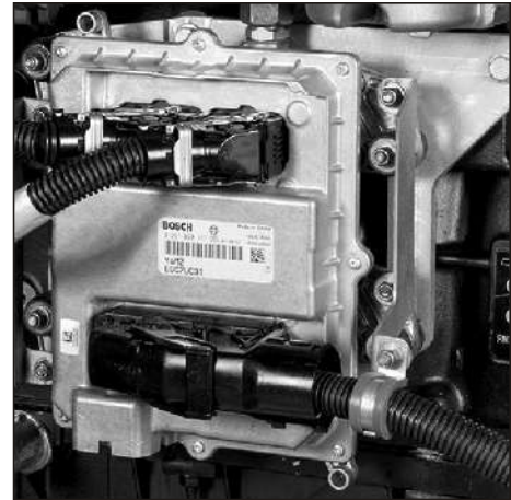
Рис. 79а. Электронный блок управления.
